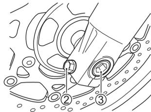
4. Remova o parafuso ② do suporte do eixo.
