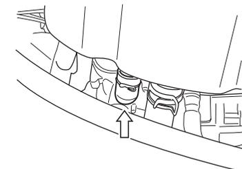
2. Retire o plugue e drene a água e o óleo no intervalo de manutenção periódica. O plugue de drenagem do filtro de ar está localizado abaixo do filtro de ar.
