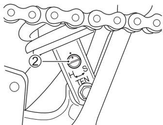
O ajustador da força de amortecimento do retorno ② está localizado na base da suspensão traseira. Para ajustar a força de amortecimento, posicione o ajustador na posição padrão e então ajuste-o na posição desejada. Para selecionar a posição padrão:
