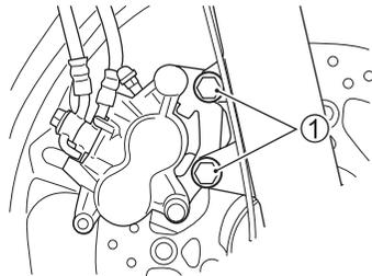
3. Remova as pinças de freio do garfo dianteiro removendo os dois parafusos ① de fixação de cada pinça.
