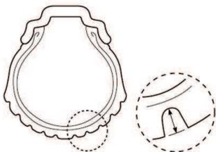
Verifique as condições diariamente antes de pilotar. Substitua os pneus se apresentarem evidências de danos, como rachaduras ou rasgos, ou se a profundidade do sulco do pneu estiver menor do que 1,6 mm para o dianteiro e menor do que 2,0 mm para o traseiro
