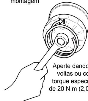
10. Marque a parte superior usando o indicador da ferramenta de filtro tipo "capa" ou no próprio filtro de óleo. Use uma ferramenta de filtro de óleo para dar duas voltas de aperto ou o torque especificado.
