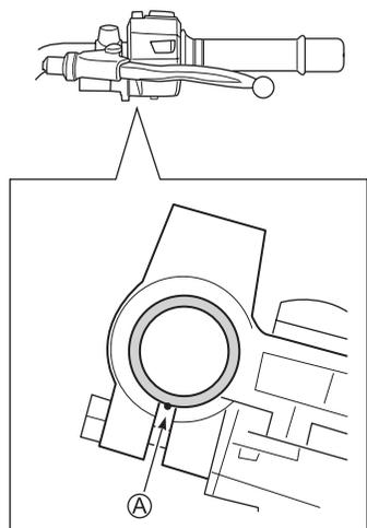
Alinha a marca ponto do guidão com a superfície de acoplamento do manete **A**.
