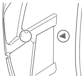
NOTA: A marca do triângulo indica o local onde as barras de desgaste estão moldadas no pneu. Quando a barra de desgaste entra em contato com o solo, indica que o limite de desgaste do pneu foi alcançado.
