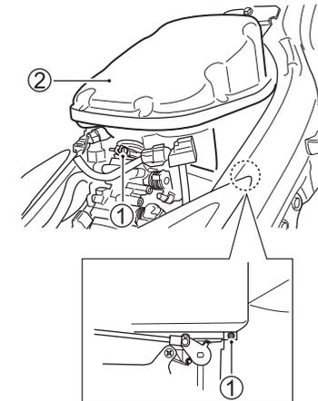
1. Solte os parafusos de fixação ①. Levante a caixa do filtro de ar ②.
