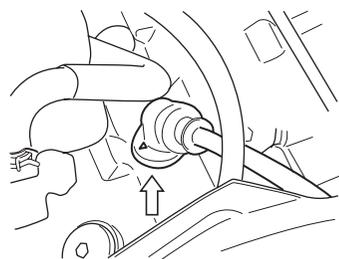
NOTA: Ao instalar a capa de vela da ignição, aponte a marca de seta da capa de vela, para o lado do escapamento.
