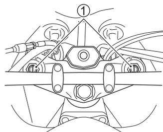
Para mudar a pré-carga da mola, gire o ajustador ① no sentido horário ou anti-horário. Girar o ajustador no sentido horário aumentará a pré-carga da mola. Girar o ajustador no sentido anti-horário reduzirá a pré-carga da mola. Existem 4 linhas na lateral do ajustador ① para sua referência. Na posição 5 você terá a pré-carga mínima e na posição 0 a máxima. Esta motocicleta sai de fábrica com o ajustador na posição 3.
