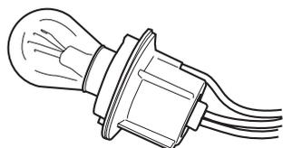
2. Pressione a lâmpada, e gire-a para esquerda enquanto pressionada. Retire a lâmpada.
