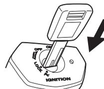
Alinhe a fenda da tampa anti-roubo com a fenda do interruptor de ignição quando for inserir a chave.
