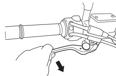
A distância entre a manopla do acelerador e o manete do freio dianteiro é ajustável em 5 posições. Para ajustar a posição, empurre o manete do freio para frente e gire o ajustador até a posição desejada. Sempre que ajustar uma nova posição do freio, certifique que o ajustador parou na posição correta. A projeção do manete do freio deverá encaixar dentro da depressão do ajustador. Esta motocicleta sai de fábrica com o ajustador na posição 3.
