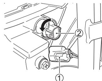
1. Desconecte o acoplador ①, vire o soquete ② para o lado esquerdo e remova-o.
