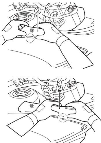
10. Empurre a carenagem ② com os polegares indicado com o círculo na imagem, para desenganchar a carenagem e os ganchos.
