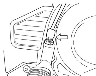
Para ajustar o interruptor da luz do freio traseiro, levante ou abaixe o interruptor para que a luz de freio acenda com um simples toque no pedal de freio.
