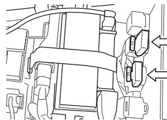
Os fusíveis ABS estão localizados sob o assento. São fornecidos dois fusíveis reservas, um de 25A e o outro de 15A, dentro da caixa de fusíveis. Eles são desenvolvidos para romper quando houver uma sobrecarga nos circuitos individuais do sistema elétrico. Se alguma operação do sistema elétrico falhar, então os fusíveis devem ser verificados.
