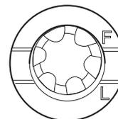
3. Segure a motocicleta verticalmente e inspecione o nível de óleo através da janela de inspeção do lado direito do motor.
