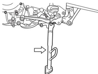
A motocicleta contém um interruptor de segurança para cortar o circuito de ignição quando o descanso lateral estiver abaixado e a transmissão em outra marcha que não a neutro.
