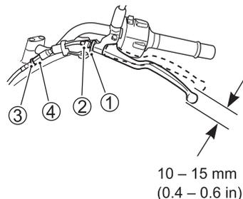
A cada intervalo de manutenção, ajustar a folga do cabo da embreagem com o regulador do cabo. A folga do cabo deve ser de 10 - 15 mm, tal como medido na extremidade da alavanca da embreagem antes do desengate. Ajuste o cabo da embreagem da seguinte forma.
