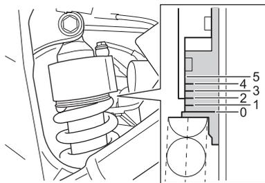
Para ajustar a pré-carga da mola da suspensão traseira, gire o ajustador ①. Girar o ajustador no sentido horário irá endurecer a pré-carga da mola e girá-lo no sentido anti-horário irá suavizar a pré-carga da mola. A posição 0 fornece uma tensão mais macia e a posição 5 uma mais rígida. Esta motocicleta sai de fábrica pré-ajustada na posição 2.
