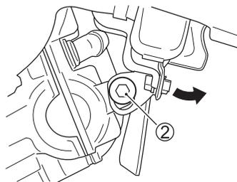
2. Retire o parafuso do radiador ② e deslize o radiador para frente.
