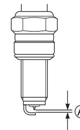
Ajuste a distância do eletrodo entre 0,7 - 0,8 mm utilizando um calibrador de lâminas. Verificar o desgaste da vela de ignição se estiver fora do padrão substituir por uma nova.
