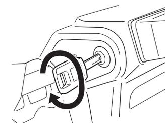
Para retirar o assento, insira a chave de ignição na fechadura e vire-a no sentido horário. Levante a parte traseira do assento e deslize-o para trás.
