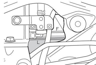
O líquido de arrefecimento deve sempre ser mantido entre as linhas "F" (Completo) e "L" (Baixo) no tanque do reservatório. Inspeção o nível com a motocicleta posicionada verticalmente antes de cada pilotagem. Se o líquido de arrefecimento estiver abaixo da linha "L" (Baixo), adicione a mistura correta do líquido da seguinte maneira.
