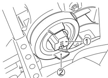
1. Desconecte o soquete ① do farol e retire a proteção de borracha ②.
