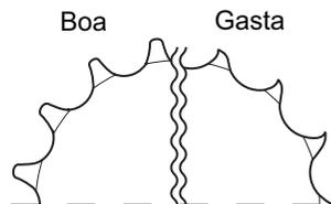
NOTA: A coroa e o pinhão devem ser inspecionados quanto ao desgaste ao se instalar uma nova corrente de transmissão e devem ser substituídos quando necessário.
