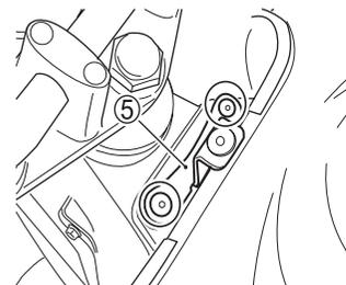
14. Retire os parafusos para remover o suporte de montagem do tanque de combustível ⑤.
