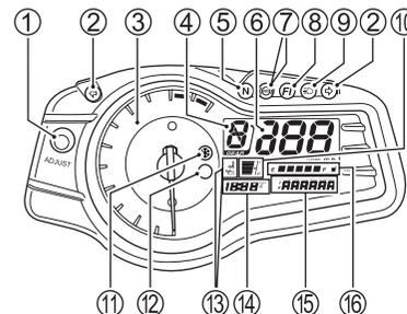
As luzes indicadoras do sistema de injeção de combustível ⑧, luz indicadora de temperatura baixa ⑩, de temperatura do líquido de arrefecimento / pressão do óleo ⑫, LCD's e tacômetro trabalham como descrito abaixo para confirmar suas funções quando o interruptor de ignição é girado para a posição "ON".
