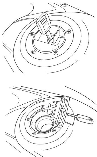
Para abrir a tampa do tanque de combustível, insira a chave de ignição na fechadura e gire-a no sentido horário. Com a chave inserida, levante a chave e abra a tampa do tanque de combustível. Para fechar o tanque de combustível, pressione firmemente a tampa para baixo com a chave inserida na fechadura.
