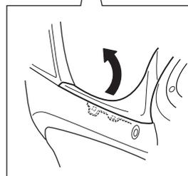
7. Desenganchar os ganchos e remover a tampa do tanque ③. As capas possuem ganchos identificados com círculo na imagem.
