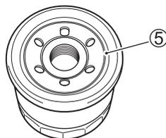
8. Espalhe uma fina camada de óleo de motor sobre a junta de borracha ⑤ do novo filtro de óleo.
