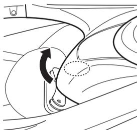
5. Retire os ganchos da tampa dianteira do tanque. As capas possuem ganchos identificados com círculo na imagem.
