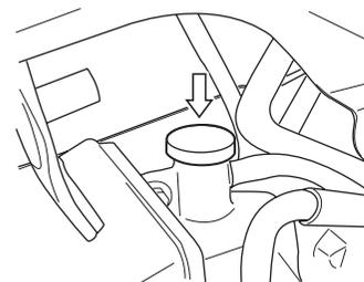
2. Retire a tampa do bocal de alimentação e adicione a solução de líquido de arrefecimento até o nível "F" (completo). Oriente-se pela seção **RECOMENDAÇÃO DE COMBUSTÍVEL, ÓLEO E LÍQUIDO DE ARREFECIMENTO**.
