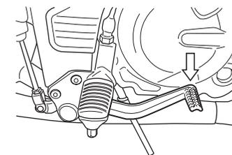
Pressione o pedal do freio traseiro para acionar o disco de freio traseiro. A luz de freio acenderá quando o freio traseiro for acionado.
