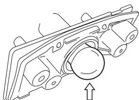
3. Pressione a lâmpada, e gire-a para esquerda enquanto pressionada. Retire a lâmpada.
