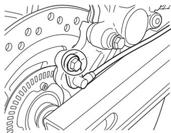
2. Remova o sensor de velocidade da roda traseira retirando o parafuso indicado.
