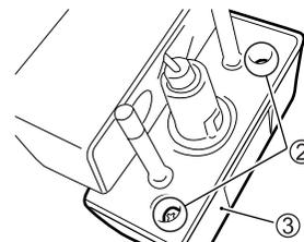
2. Retire os parafusos ② e retire para fora da tampa com a lente ③.
