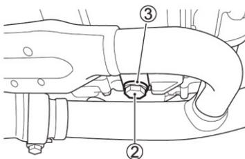
3. Retire o bujão de drenagem (2) e a junta (3) da parte inferior do motor com uma ferramenta adequada, posicione um recipiente adequado embaixo do bujão e drene o óleo do motor.
