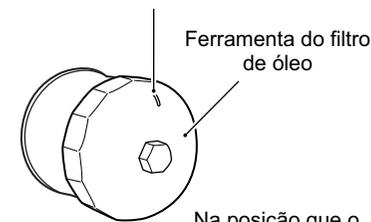
Na posição que o filtro tem o primeiro contato com a superfície de montagem.
