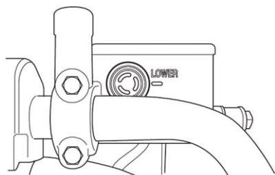
O mecanismo de embreagem desta motocicleta é acionado hidráulicamente. Não há nenhum ajuste que precise ser feito no sistema. Porém, inspecione o sistema antes de pilotar para ter certeza que está em condições adequadas de funcionamento.
