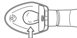
2. Pressione a lâmpada girando-a para a esquerda e depois retire-a.
