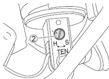
O ajustador da força de amortecimento do retorno ② está localizado na base da suspensão traseira. Para ajustar a força de amortecimento, posicione o ajustador na posição padrão e então ajuste-o na posição desejada. Para selecionar a posição padrão:
