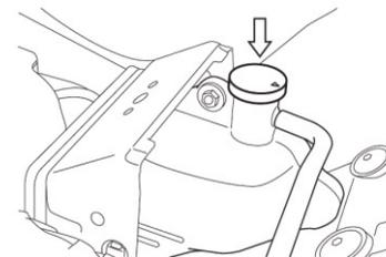
2. Retire a tampa do bocal de alimentação e adicione a solução de líquido de arrefecimento até o nível "F" (completo). Oriente-se pela seção RECOMENDAÇÃO DE COMBUSTÍVEL, ÓLEO E LÍQUIDO DE ARREFECIMENTO.
