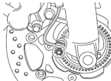
2. Remova o sensor de velocidade da roda da frente retirando o parafuso indicado.
