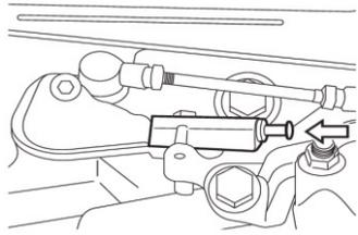
Verifique se o descanso lateral / interruptor de segurança da ignição está funcionando adequadamente como orientado a seguir.
