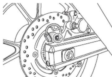
2. Remova o sensor de velocidade da roda traseira retirando o parafuso indicado.
