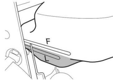
O líquido de arrefecimento deve sempre ser mantido entre as linhas "F" (Completo) e "L" (Baixo) no tanque do reservatório. Inspeção o nível com a motocicleta posicionada verticalmente antes de cada pilotagem. Se o líquido de arrefecimento estiver abaixo da linha "L" (Baixo), adicione a mistura correta do líquido da seguinte maneira.
