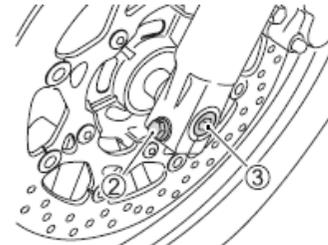
4. Remova os parafusos ② do eixo.
