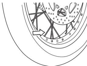
Checar a tensão dos raios para verificar o aperto dos mesmos. A tensão pode ser verificada ao pressioná-los com uma pequena barra de metal. Se algum raio estiver solto, o som será monótono. Para apertar os raios corretamente, aperte-os igualmente com um torque específico. Frouxo demais ou apertado demais, pode causar tensão diferente nos raios e resultar em distorção do aro da roda. Consulte uma concessionária autorizada Jtoledo Suzuki para que esse serviço seja realizado.
