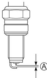
Ajuste a distância do eletrodo com 0,8 - 0,9 mm utilizando um calibrador de lâminas. Verificar o desgaste da vela de ignição, e se estiver fora do padrão substitua por uma nova.
