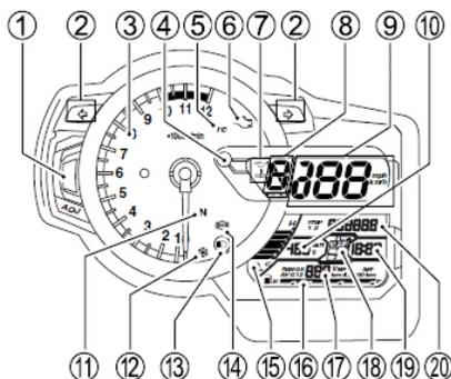
As luzes indicadoras do sistema de injeção de combustível ⑥, luz indicadora de temperatura baixa ⑫, de temperatura do líquido de arrefecimento / pressão do óleo ④, luz indicadora de ABS ⑭, luz indicadora de controle de tração ⑤, LCD's e tacômetro trabalham como descrito abaixo para confirmar suas funções quando o interruptor de ignição é girado para a posição "ON".
