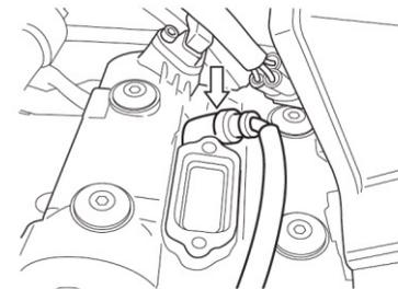
NOTA: Ao instalar a capa de vela da ignição, aponte a marca de seta da capa de vela, para o lado do escapamento.
