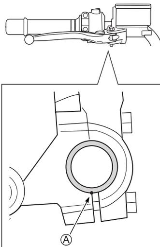
Alinha a marca ponto do guidão com a superfície de acoplamento do manete **A**.
