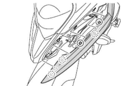
5. Remova a lateral do desencaixando as travas.
