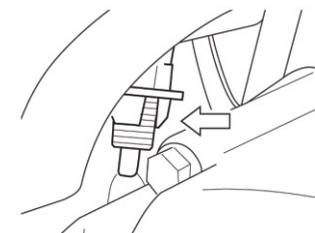
Para ajustar o interruptor da luz do freio traseiro, levante ou abaixe o interruptor para que a luz de freio acenda com um simples toque no pedal de freio.
