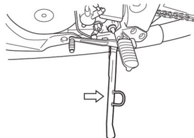
A motocicleta contém um interruptor de segurança para cortar o circuito de ignição quando o descanso lateral estiver abaixado e a transmissão em outra marcha que não a neutro.
