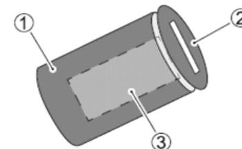
É fornecida uma tampa ② para o cilindro chave ① para evitar adulteração. Virando o A posição da tampa cobre o orifício de fechadura ③, para evitar que qualquer substância alienígena entre o buraco da fechadura. Para girar a tampa, insira o ponta da chave ligeiramente na tampa e vire-o.
