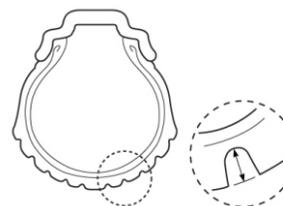
Verifique as condições diariamente antes de pilotar. Substitua os pneus se apresentarem evidências de danos, como rachaduras ou rasgos, ou se a profundidade do sulco do pneu estiver menor do que 1,6 mm para o dianteiro e menor do que 2,0 mm para o traseiro.
