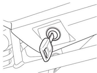
Para retirar o assento, insira a chave de ignição na fechadura e vire-a no sentido horário. Levante a parte traseira do assento e deslize-o para trás.
