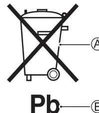
Este símbolo ① localizado na etiqueta da bateria indica que as baterias usadas devem ser recolhidas separadamente, diferentemente do lixo doméstico.
