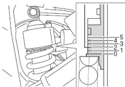
Para ajustar a pré-carga da mola da suspensão traseira, gire o ajustador ①.
