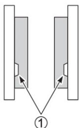
Inspeccione as pastilhas dianteiras e traseiras, verificando se o desgaste não está abaixo da marca limite ①. Se as pastilhas estiverem desgastadas abaixo da marca limite as mesmas devem ser substituídas por pastilhas novas em uma Concessionária Autorizada Suzuki J Toledo.
