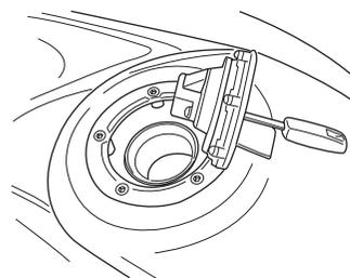
Para abrir a tampa do tanque de combustível, insira a chave de ignição na fechadura e gire-a no sentido horário. Com a chave inserida, levante a chave e abra a tampa do tanque de combustível. Para fechar o tanque de combustível, pressione firmemente a tampa para baixo com a chave inserida na fechadura.
