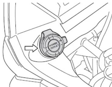
A V-STROM650A/XT/AD vem equipada com um terminal elétrico para a fixação de acessórios elétricos 12V. Acessório elétrico deve ter uma potência inferior a 36W. Confira a tensão elétrica e potência antes de colocar o acessório na saída do terminal.
