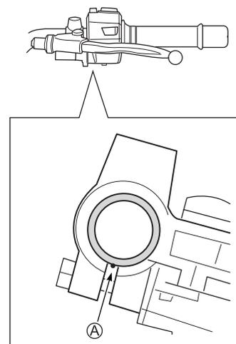
Alinha a marca ponto do guidão com a superfície de acoplamento do manete **A**.
