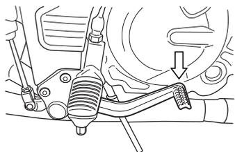
Pressione o pedal do freio traseiro para acionar o disco de freio traseiro. A luz de freio acenderá quando o freio traseiro for acionado.
