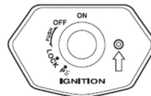
O indicador do immobilizador pisca 2 vezes em que o interruptor de ignição é ligado. Então, o indicador acende-se em 2 segundos e sai. O sistema immobilizador foi projetado para ajudar a evitar o roubo de motocicletas por via eletrônica desativando o motor começando sistema. O motor pode ser iniciado apenas com as chaves originais que tem um código de identificação eletrônico programado para isso. A chave se comunica o código de identificação para o ECM quando a chave é girada para "ON» posição.
