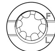
3. Segure a motocicleta verticalmente e inspecione o nível de óleo através da janela de inspeção do lado direito do motor.
