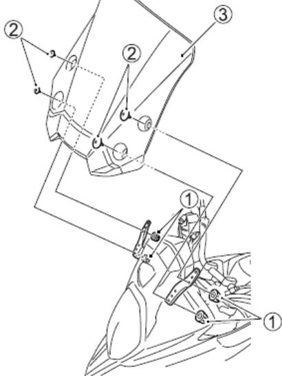
1. Retire as capas ① e os parafusos ② e retire o pára-brisa ③.
