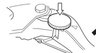
A distância entre a manopla do acelerador e o manete do freio dianteiro é ajustável em 5 posições. Para ajustar a posição, empurre o manete do freio para frente e gire o ajustador até a posição desejada. Sempre que ajustar uma nova posição do freio, certifique que o ajustador parou na posição correta. A projeção do manete do freio deverá encaixar dentro da depressão do ajustador. Esta motocicleta sai de fábrica com o ajustador na posição 3.
