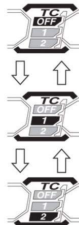
3. Pressione o botão do sistema de controle de tração ⑥ para cancelar a seleção de modo, o visor do modo de seleção volta ao modo normal.
