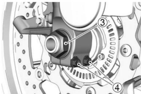
6. Solte os parafusos do suporte do eixo **5**.
